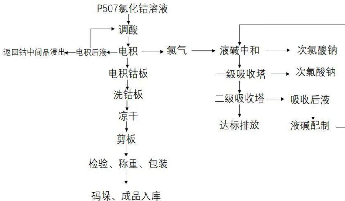
图 2.4-3 钴中间品生产硫酸钴、氯化钴、钴电积工艺流程
